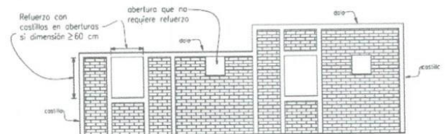
Figura 5.7.2 Refuerzo en el perímetro de aberturas
